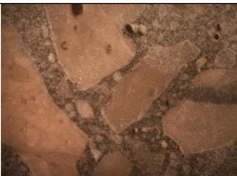
Posterior efeito secundário (não irrelevante) a ser considerado positivamente é o efeito compactante para a autocompressão (*self compressing*) e de incremento dos contatos (*wall effect*) do agente expansor que empurra e pressiona as massas do aglomerado de cimento (concreto): o efeito expansor,
