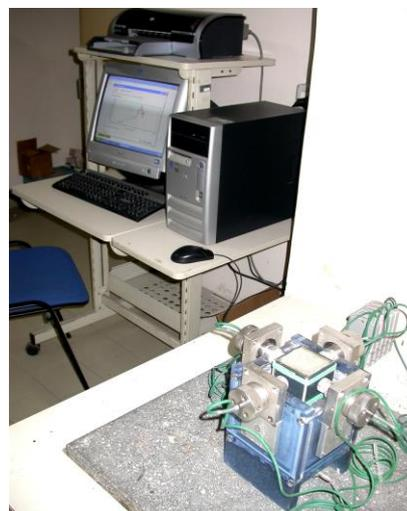
Acima: dados de testes segundo ASTM 878 – Acima à direita e abaixo: equipamento e software para teste retração/expansão livre/ conforme Método de Gennaro
