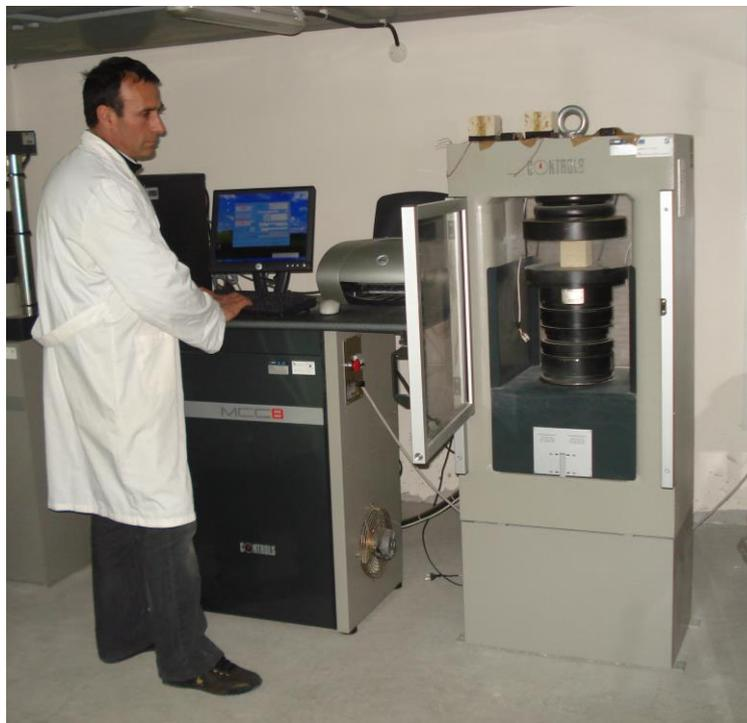
**Foto:** Prensa (carga máxima 3000 kN) utilizada para a determinação da resistência à compressão (Departamento de Ciências da Terra – Universidade dos Estudos de Nápoles Federico II)
