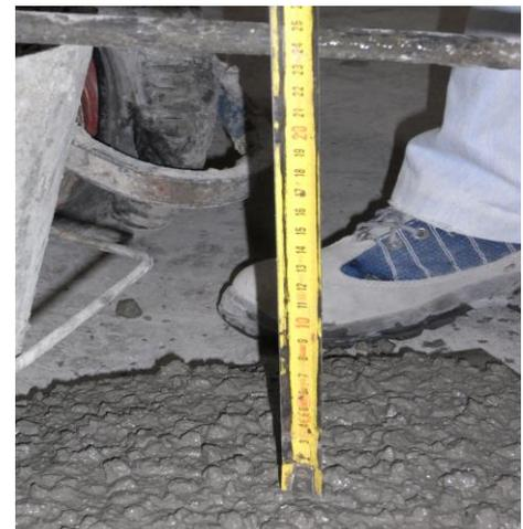
Para as classes de exposições (UNI 11104 e NTC- Normas Técnicas para as Construções), a dosagem usada para o MIX FINAL/IDEAL (MIX n° A4) supera os mínimos impostos pela normativa vigente também para XA2/ataque químico água, XD2/cloretos, XF2-XF3/gelo-desgelo, XC4/carbonatação ( $a/c = 0,42 < 0,45 < 0,50$ ).
