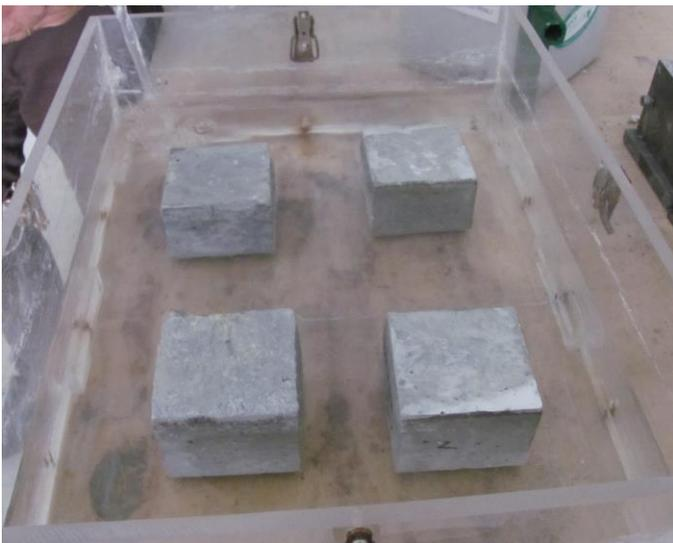
Foto – Teste de absorção de água
