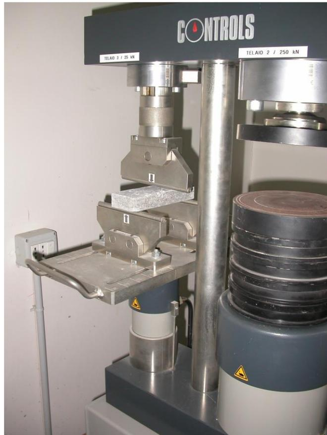
**Foto:** Prensa (carga máxima 25kN) utilizada para a determinação da resistência à tração (Departamento de Ciências da Terra – Universidade dos Estudos de Nápoles Federico II)
