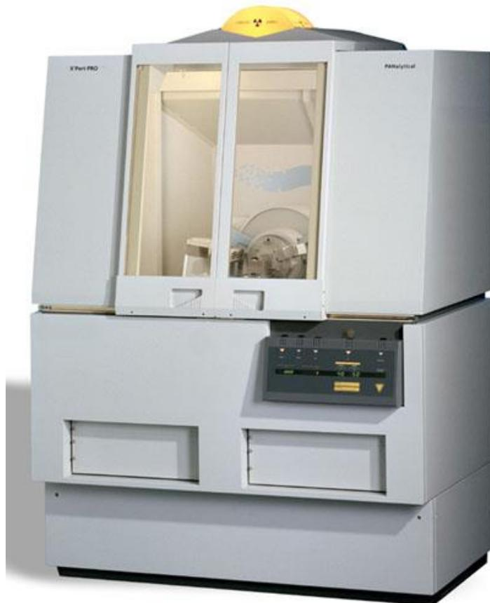
**Foto:** Difratorômetro automático Panalytical X'Pert PRO PW 3040/60 com detector RTMS X'celerator e unidade MPD PW 3710 (Departamento de Ciências da Terra – Universidade dos Estudos de Nápoles Federico II)
